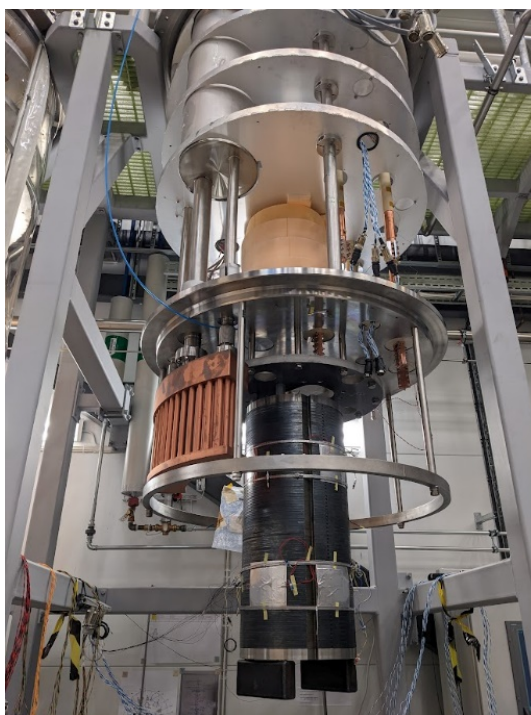
A SuShi szeptum mágnes az Uppsalai Egyetem "Gersemi" kriosztátjának belső struktúrájára szerelve.
