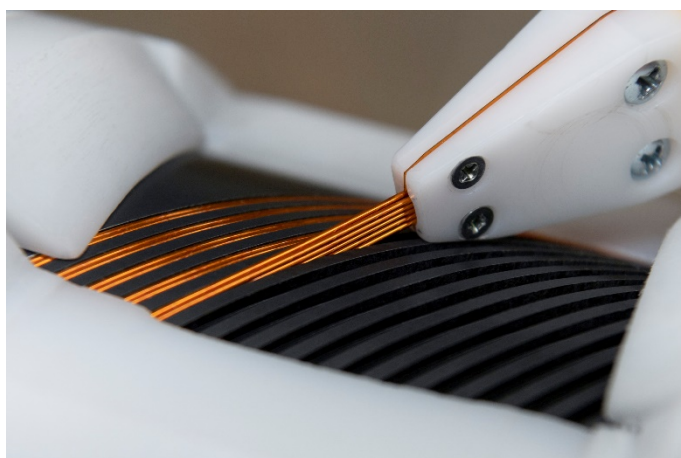
A SuShi szupravezető mágnes tekercselése.
